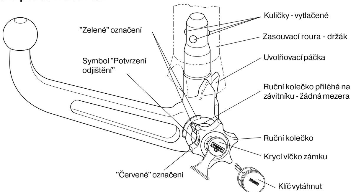
**Odjištěná pozice Vyndání kulové tyče**
