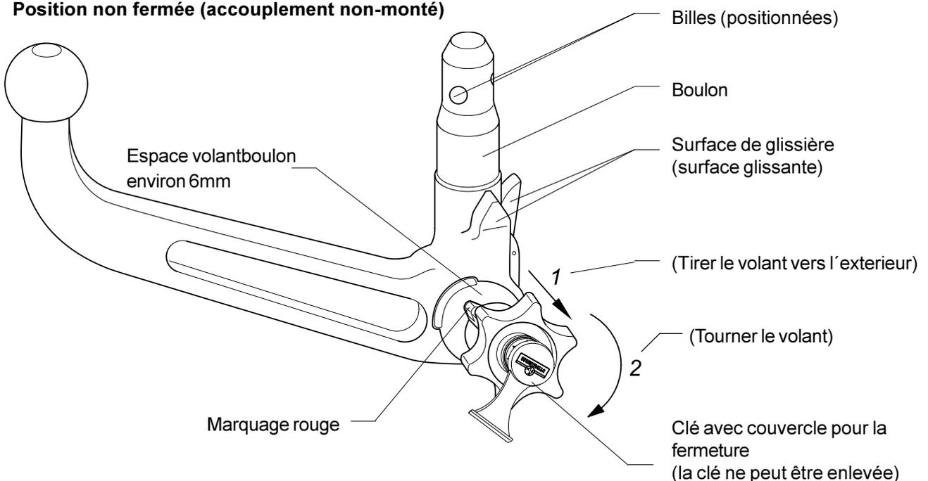
Direktiivin 94/20/EG mukainen hyväksymisnumero: **e13 00-1599**Luokka: **A50-X** Tyypin: **346 016**Tekniset tiedot: Suurin D-arvo: **15,3 kN**Suurin koukkukuorma: **140 kg**
