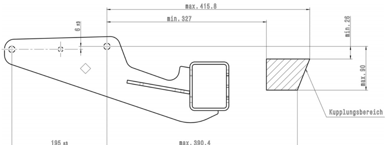
Kuppelbereich für Kupplungskugeln mit Halterung oder selbsttätige Bolzenkupplungen.
