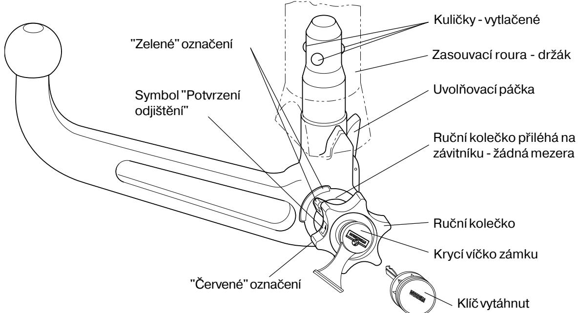
**Odjištěná pozice Vyndání kulové tyče**
